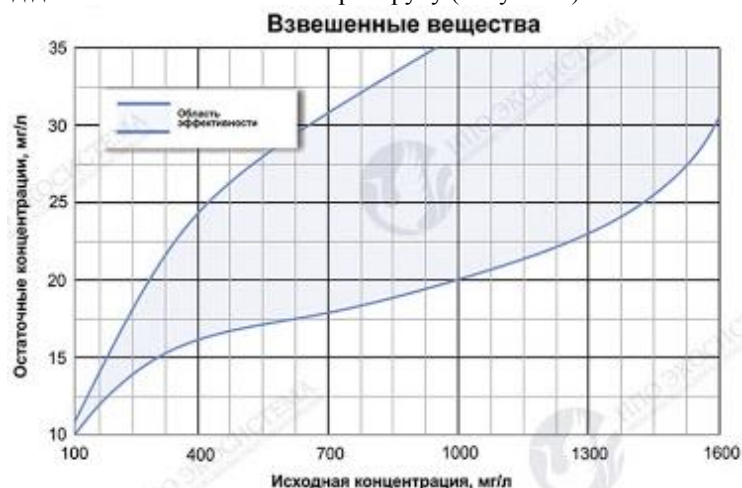
Рисунок 1 – Эффективность контактного отстойника при работе с взвешенными веществами Источник: Отстойник воды ОГЖФ с жидкостным фильтром [1].
