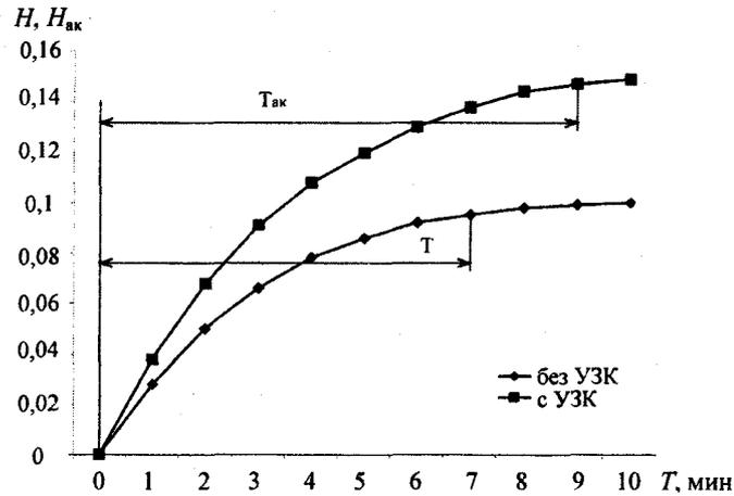
Рис. 3. Типичная зависимость интегрального линейного износа корундового образца от продолжительности его истирания о поверхность диска, шаржированную в обычных условиях ( $H$ ) и с ультразвуком ( $H_{ак}$ ) при  $\alpha = 90^\circ$  ( $T$  и  $T_{ак}$  – соответствующие этим условиям шаржирования периоды стойкости полученного на поверхности диска алмазосодержащего покрытия)
