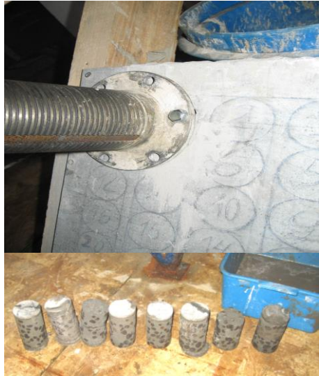
Рисунок 6. – Схема расположения мест оценки скорости ультразвука (а) и выбуривания образцов (б) для оценки плотности и прочности
