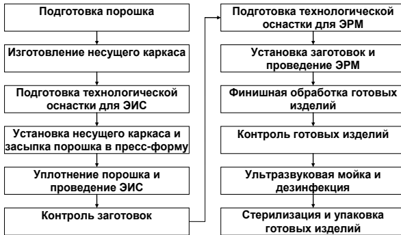
Рисунок 25. – Основные технологические операции получения имплантатов
