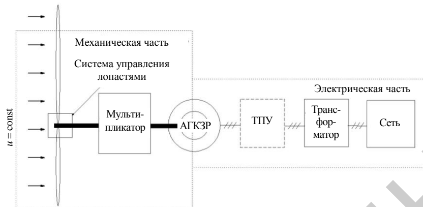
Рис. 2. Концепция управления с постоянной скоростью
