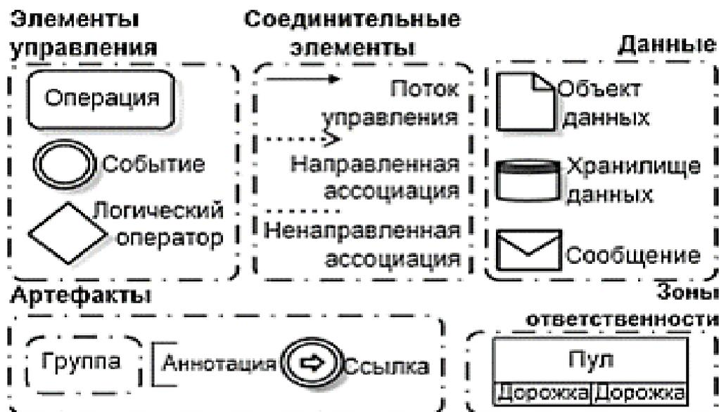
Рисунок 2 – Основные графические элементы в нотации BPMN
