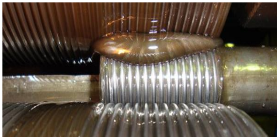
Рисунок 4 – Процесс накатки резьбы Источник: [2]
