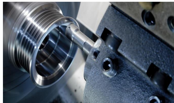
Рисунок 2 – Точение резьбы на внешней и во внутренней поверхности заготовки
