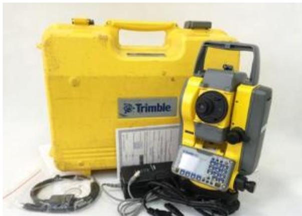
Рисунок 4 – Тахеометр Trimble M3
