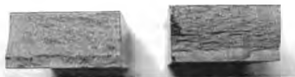
Рис. 5. Разрушения образца из стали 65Г с микроструктурой мартенсита отпуска после испытания на ударную вязкость
