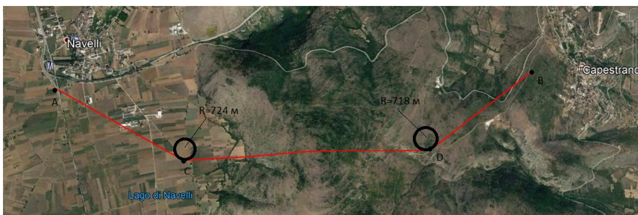
Рисунок 1 – Трассировка и продольный профиль тоннеля
