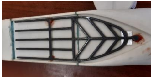
Рис. 3. Трубчато-перфорированная конструкция подачи воздуха
