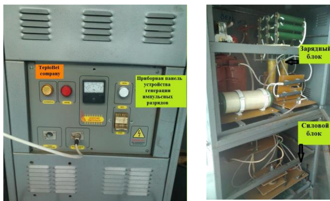
Рис. 3. Внешний вид устройства, преобразующего энергию в импульсы тока микросекундной длительности для электрогидравлической обработки отходов
