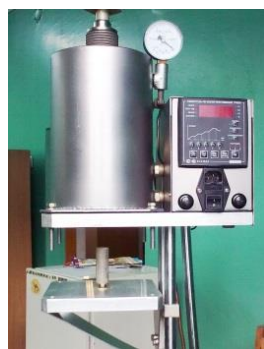
Рис. 6.42. Устройство получения стеклокерамических ФГМ в вакууме: 1 – импульсный генератор с блоком управления; 2 – вакуумная камера; 3 – пресс-форма с шихтой; 4 – индикатор перемещения; 5 – электрод верхний; 6 – вакуумметр; 7 – электрод нижний; 8 – кран; 9 – насос вакуумный а – функциональная схема; б – внешний вид
