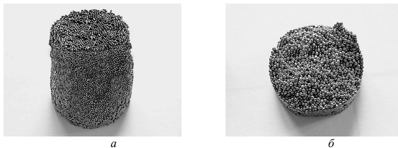
Рис. 4.29. Многослойный пористый образец из сферического порошка титана ВТ1-00 гранулометрического состава (-0,315+0,2) мм: a – внешний вид; б – поперечный излом
