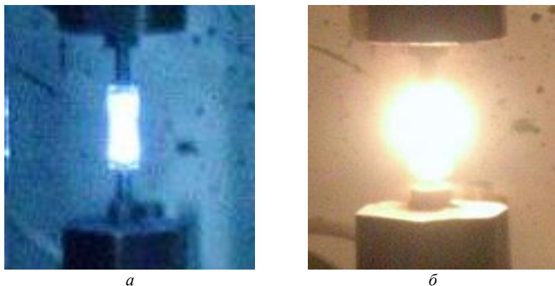
Рис. 3.25. Световая вспышка при ЭИС порошка: а – титана; б – ниобия
