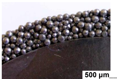
Рис. 6.3. Пористый слой из сферических частиц титана на поверхности имплантата
