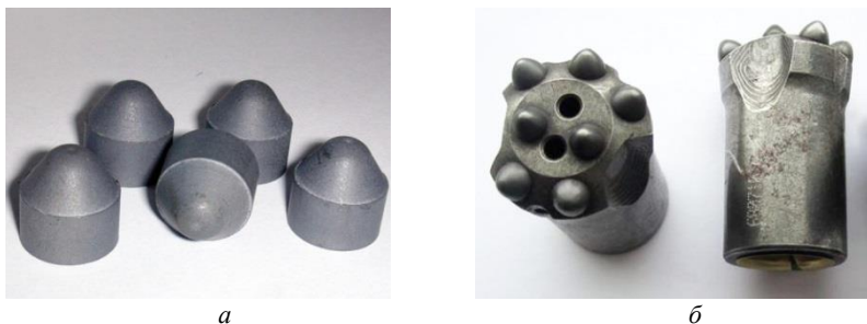
Рис. 6.40. Зубки шарошечных головок бурового инструмента а – твердосплавные зубки; б – головки бурового инструмента
