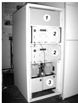
Рис. 4.3. Лазерное устройство: 1 – лазерный излучатель; 2 – блоки питания; 3 – система охлаждения
