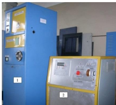
Рис. 5.3. Основные конструктивные блоки установки ИПМ: 1 – технологический блок; 2 – высоковольтный разрядный блок с модулем управления
