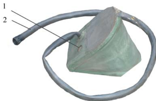
Рис. 1.44. Мех: 1 – шланг; 2 – клапан
