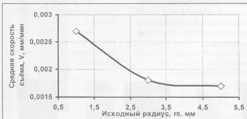
Рис. 6. Зависимость усреднённой скорости съема материала от исходного радиуса образцов при вертикальном их расположении в электролите
