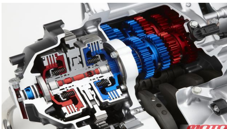
Рис. 4 – Роботизированная коробка передач с двумя сцеплениями
