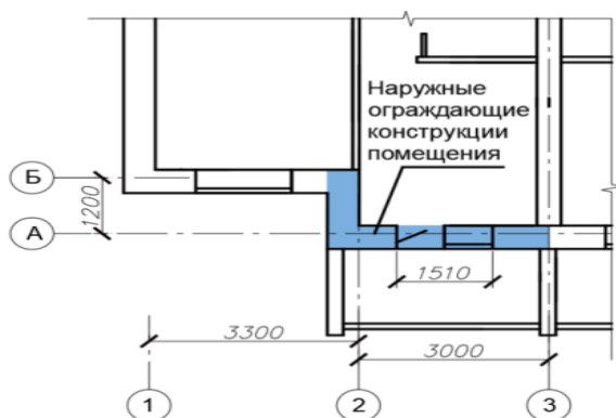
Рис. Геометрические показатели наружных стен помещения
