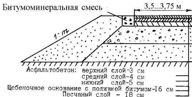
Рис. 1.13. Дорожная одежда с асфальтобетонным покрытием
