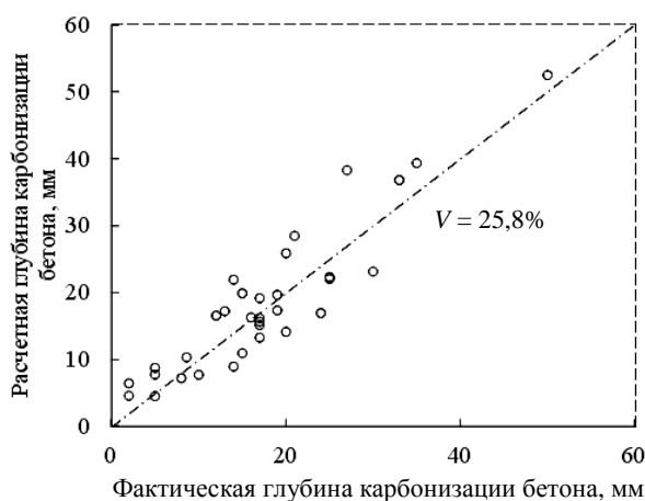
Рисунок 2. – Соотношение фактических и расчетных значений карбонизации бетона мостовых железобетонных конструкций
