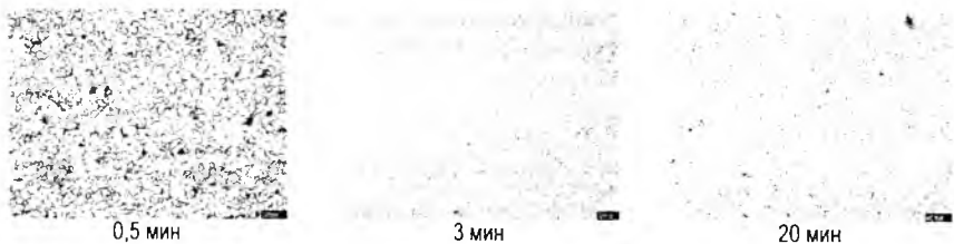
Рисунок 5. Структура поверхностного слоя после ЭПО (x100).
