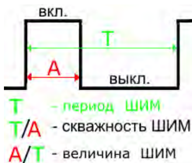
Рис. 5.13. Схема ШИМ сигнала
