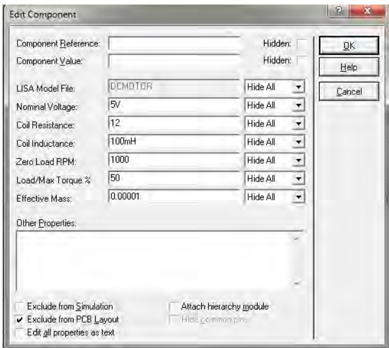
Рис. 3.4. Изменение параметров двигателя: nominal voltage – номинальное напряжение; coil resistance – сопротивление катушки; coil inductance – катушки индуктивности; Zero load – нулевая нагрузка; Torque – крутящий момент; Effective mass – эффективная масса
