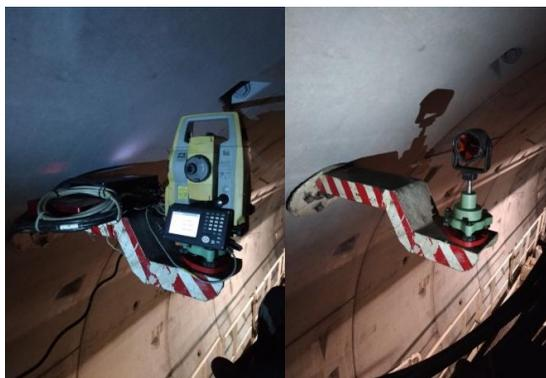
Рис. 5. Тахеометр и призма на консоли
