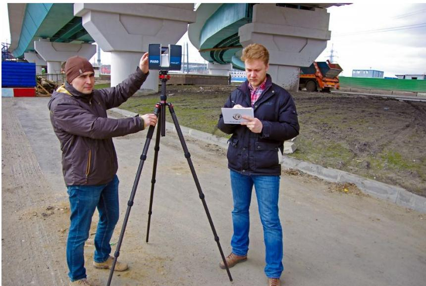
Рис. 3. Пример наземного сканирования
