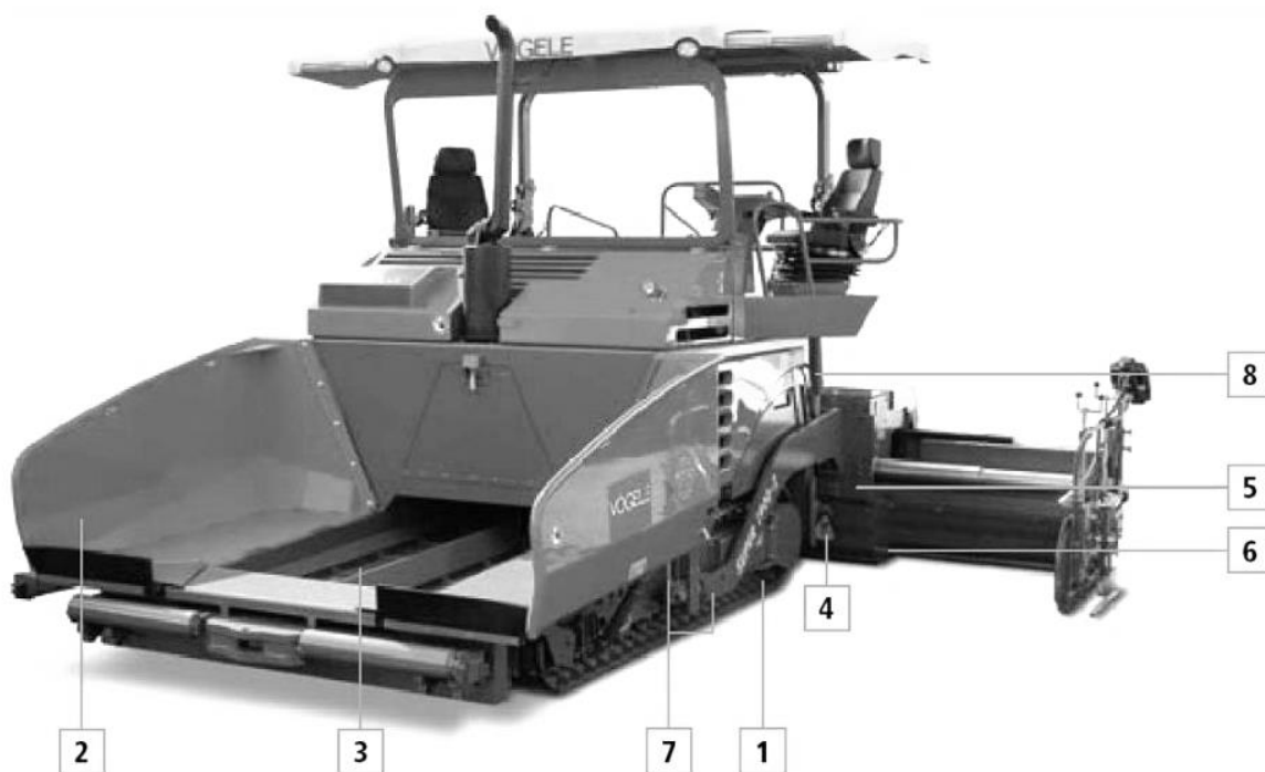
Рисунок 10 – Общий вид гусеничного асфальтоукладчика: 1 – ходовая часть; 2 – приемный бункер; 3 – питатель; 4 – распределительные шнеки; 5 – рабочий орган; 6 – нагреватель; 7 – подсистема регулирования высоты цилиндрами системы нивелирования; 8 – подсистема разгрузки рабочего органа
