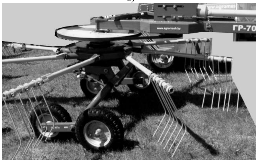
Рисунок 9 – Ротационные грабельные рабочие органы: а) с гидроприводом; б, в) с механическим приводом
