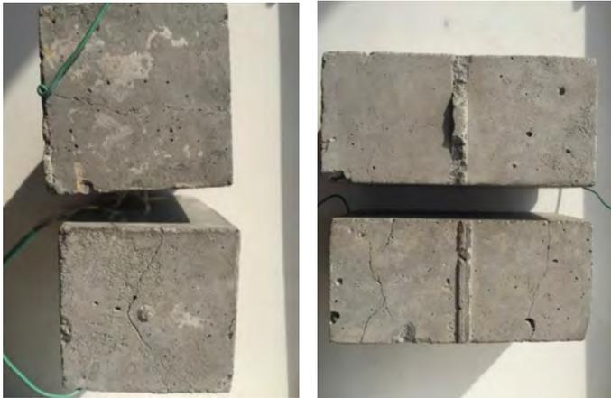
**Рисунок 3.** Фотографии образцов бетона на песчаном цементе после 1–2-х циклов насыщения-высушивания
