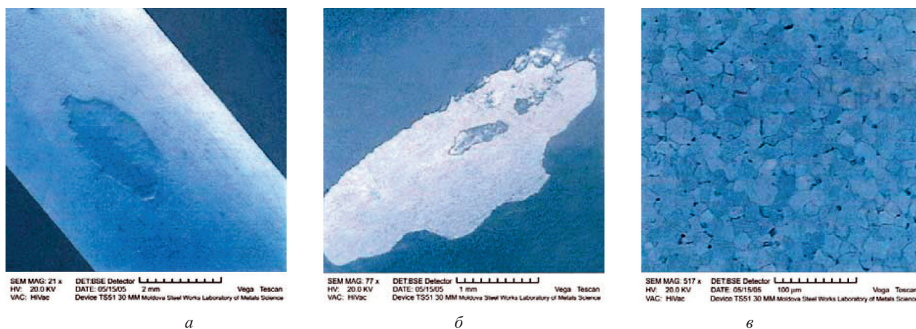
Рис. 5. Внешний вид «пятен» (а, б) и структуры на поверхности катанки (в). РЭМ: а – во вторичных электронах; б, в – в отраженных электронах
