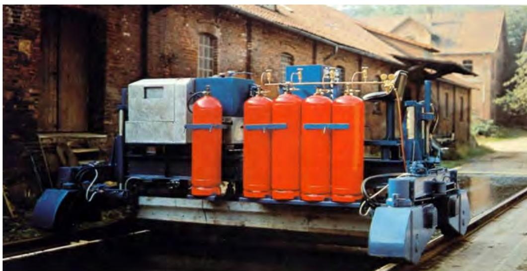
Рисунок 3 - Укладка литой асфальтобетонной смеси (I тип) с помощью финишера AE-GDF
