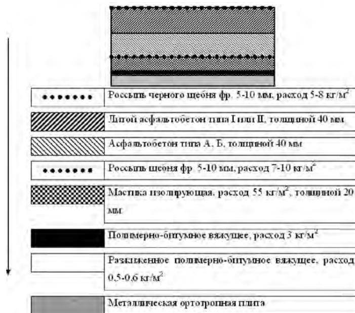
Рисунок 1 - Конструкции дорожной одежды мостового полотна, рекомендуемые к применению на металлической ортотропной плите
