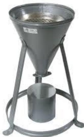
Рис. 5. Стандартная воронка и мерный цилиндр
