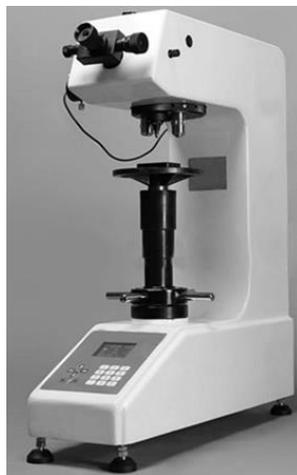
Рис. 8. Прибор типа ТШ
