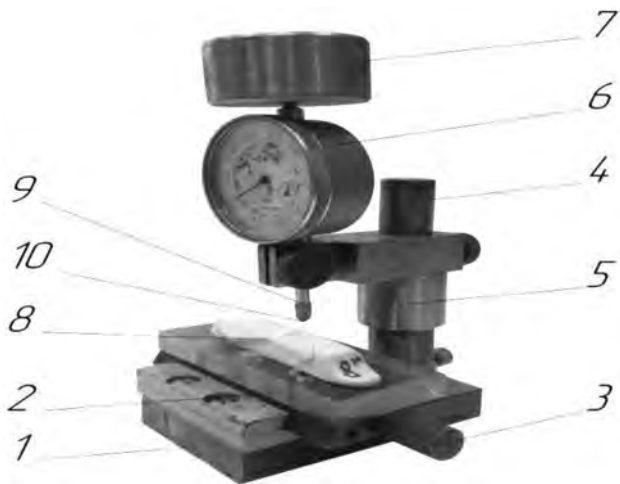
Рис. 1. Прибор для измерения твердости красок: 1 – основание; 2 – рабочий стол; 3 – винт; 4 – штатив; 5 – винтовая втулка; 6 – индикатор со шкалой; 7 – груз; 8 – лодочка с образцом краски; 9 – индентор; 10 – конус из твердосплавного материала
