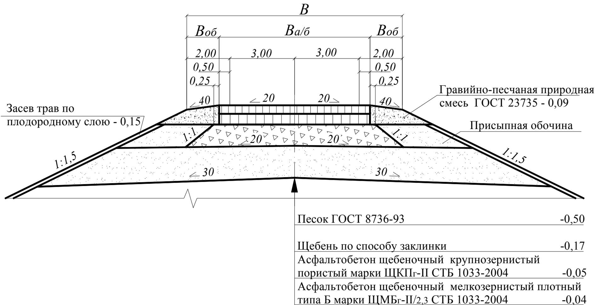
Рис. 1 – Пример конструкции дорожной одежды IV технической категории
