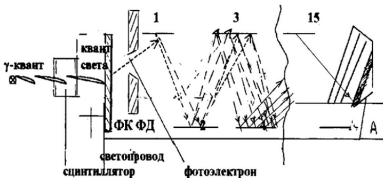
Рис. 1.10. Схема и принцип работы сцинтилляционного счетчика: 1-4, 15 – диоды ФЭУ; А – анод; ФК – фотокаатод; ФД – фокусирующая диафрагма
