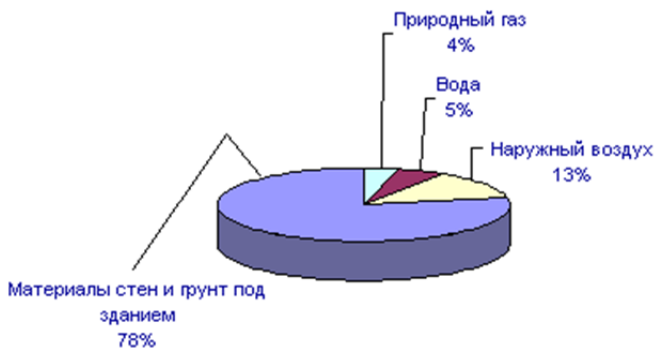
Рис. 2.3. Источники поступления радона в помещение
