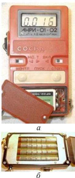
Рис. 2.5. Бытовой радиометр «Сосна»: а – батарейный отсек приоткрыт. Показывает 16 микро-рентген/час; б – блок детекторов прибора «Сосна». Видны 4 счетчика Гейгера СБМ-20 и часть корректора спектра чувствительности (свинцовая фольга справа)
