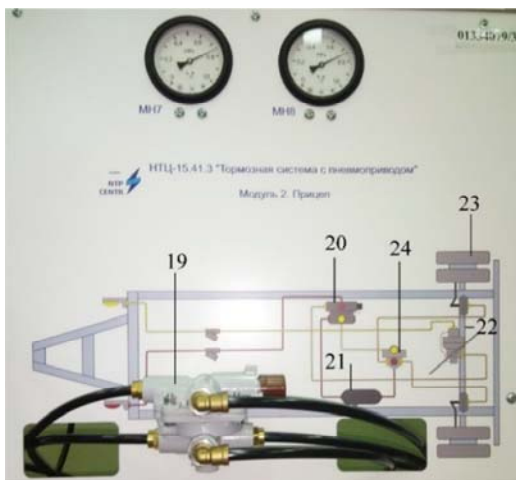
Рис. 3.10. Пневматический тормозной привод прицепа 19, 20 – воздухораспределитель тормозов прицепа; 21 – ресивер прицепа; 22 – регулятор тормозных сил прицепа; 23 – колесо прицепа; 24 – ускорительный клапан прицепа
