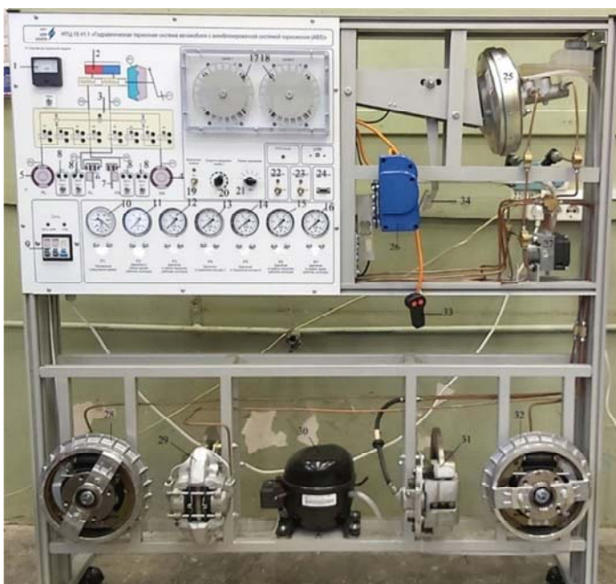
Рис. 2.1. Общий вид стенда с гидравлической тормозной системой
