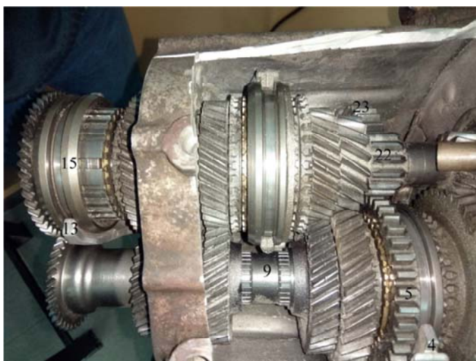
Рис. 1.8. Включение передачи заднего хода
