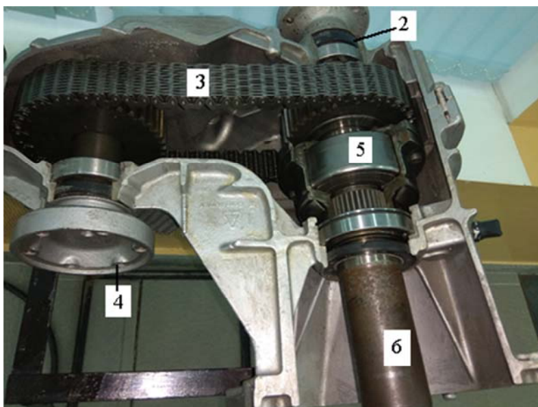
Рис. 3.4. Учебный стенд раздаточной коробки с самоблокирующимся дифференциалом
