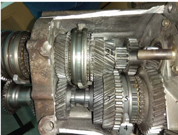
Рис. 1.4. Включение 2-ой передачи
