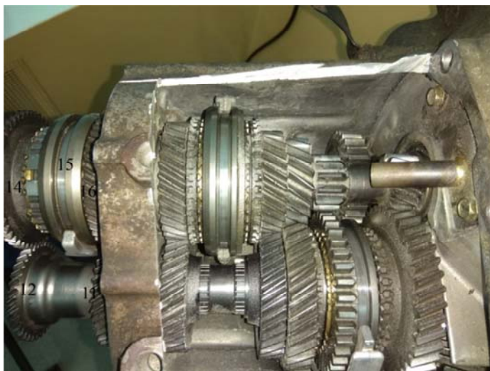
Рис. 1.7. Включение 5-ой передачи
