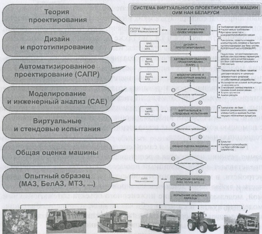
Рисунок 2 — Система виртуального проектирования автотракторной техники РКЦМП
