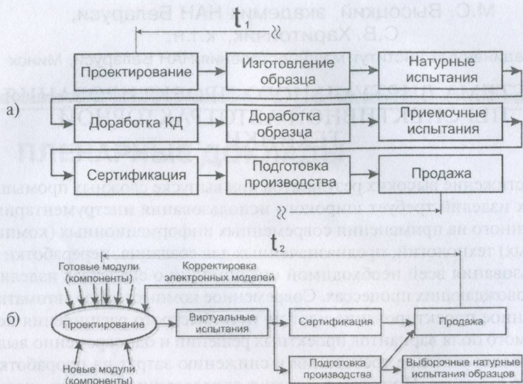
Рисунок 1 — Традиционный (а) и перспективный (б) методы создания автотракторной техники
