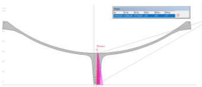
Рис. 6. Расчетное поперечное сечение гиперболической оболочки, с эпюрой напряжений
