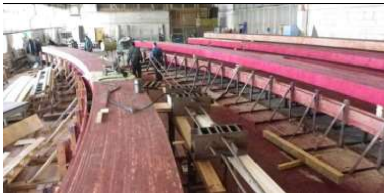
Рис. 2. Испытание полуарки стрельчатого очертания на заводском стенде
