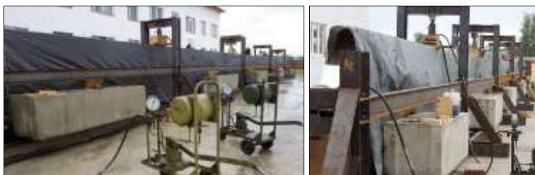
Рис. 7. Фрагмент нагружения клееных балок в испытательной установке
