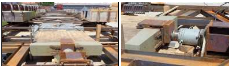
Рис. 14. Нагружение клееных полуарок горизонтальной нагрузкой при помощи домкрата
