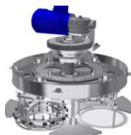
Рис. 4. Планетарный механизм с цепным зацеплением
