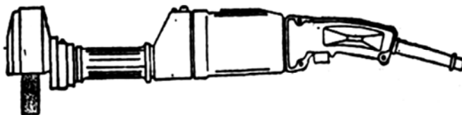
Рис. 2.12. Ручная шлифовальная электрическая машина ИЭ 2004А УЗ
