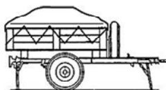
Передвижная зарядная электростанция на одноосном прицепе ЭСБ-4В3
