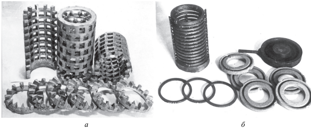
Рис. 8. Отливки, полученные методом разделения твердой и жидкой фаз: а – заготовки сепараторов подшипников; б – стержневой ящик, стержни, поршневые кольца
