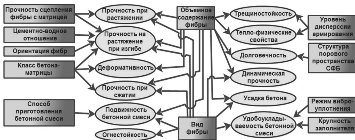
Рис. 1. Взаимосвязь между параметрами и физико-механическими свойствами сталефибробетона
