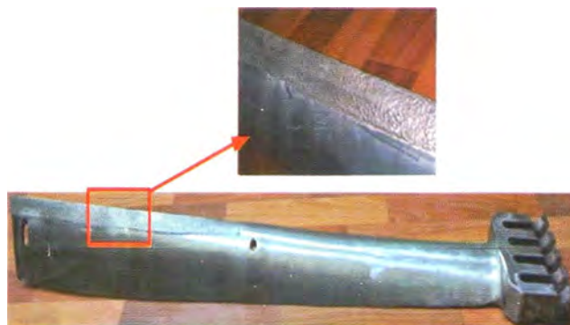
Рис. 5. Внешний вид рабочей лопатки последней ступени паровой турбины с ЭИЛ со стеллитовым покрытием на входной кромке
