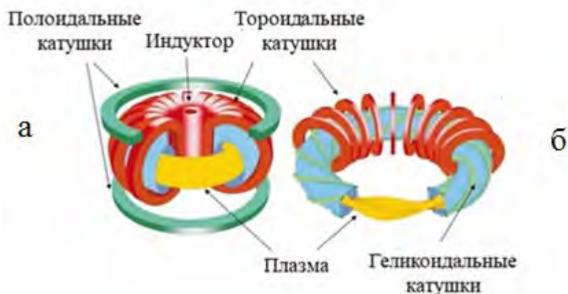
Рисунок 1 - Схемы термоядерных реакторов «токамак» (а) и «стелларатор» (б).
