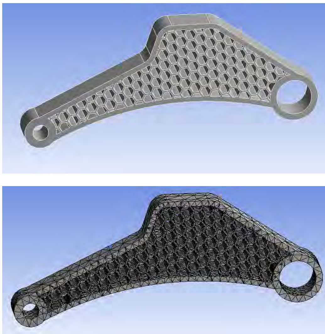
Рисунок 1 – Вид рычага и конечно-элементная модель
