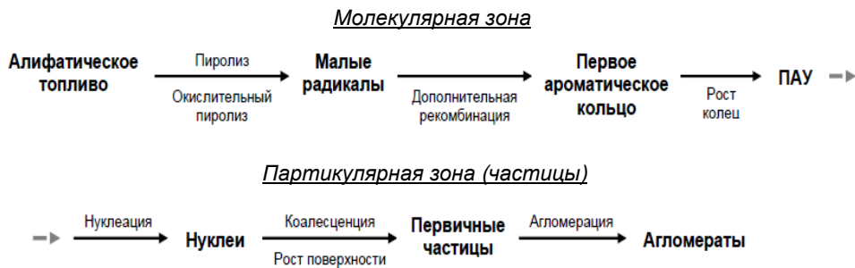
Рис. 5. Схема формирования сажи
