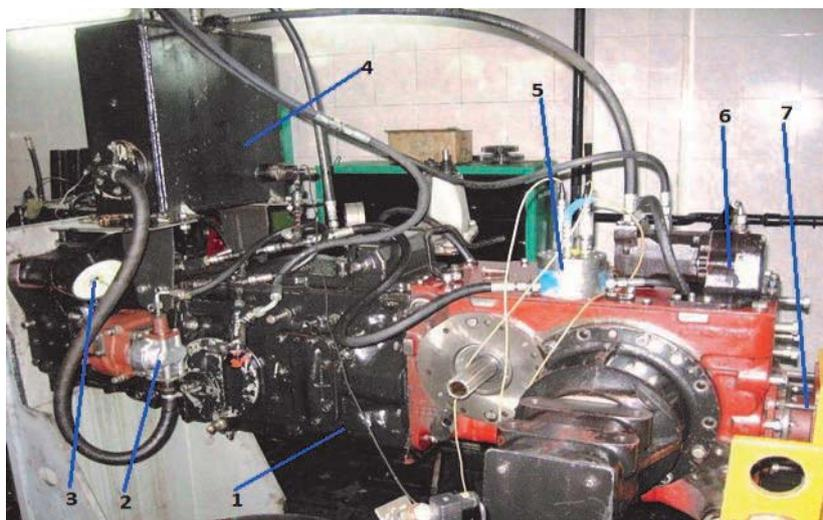
**Рисунок 4 — Двухпоточная передача заднего вала отбора мощности, разработанная для трактора «БЕЛАРУС 1221»:**
