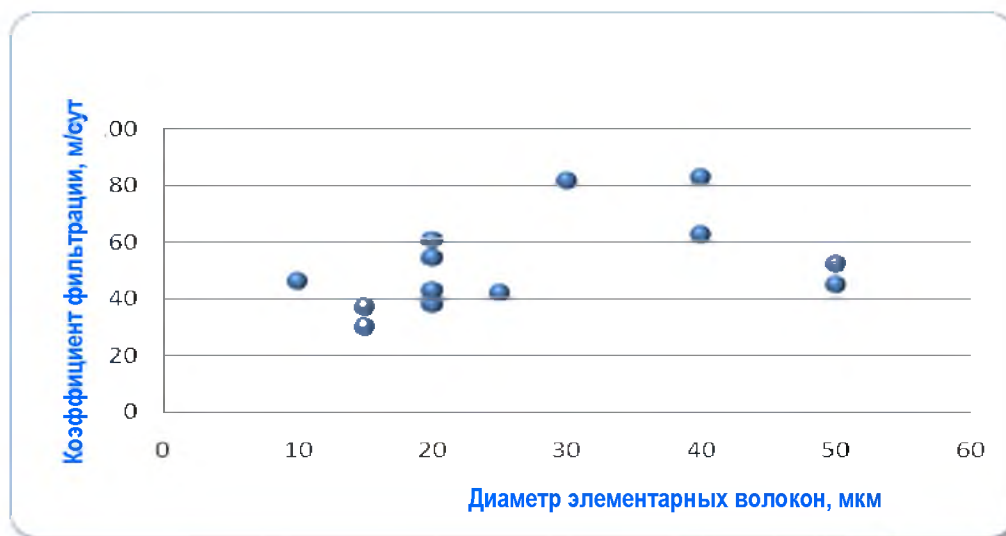
Рисунок 7 – Влияние диаметра элементарных волокон на коэффициент фильтрации геотекстиля
