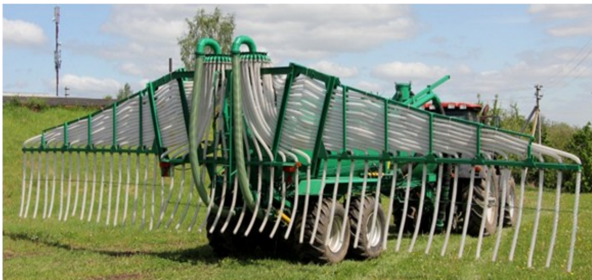
а) с адаптером штанговым для поверхностного внесения жидкого навоза
