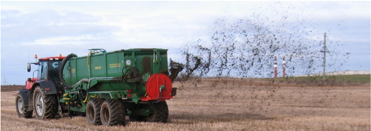
Рисунок 2 – Прицепная машина МПН-16, агрегатируемая с трактором "БЕЛАРУС" в работе
