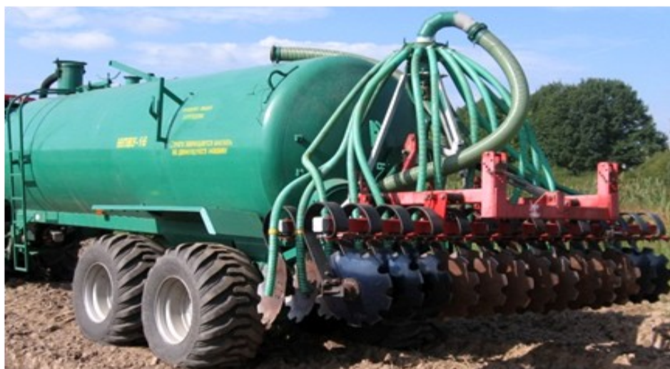
б) с адаптером дисковым для подпочвенного внесения жидкого навоза
