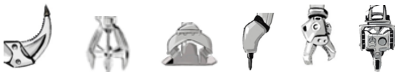
Рисунок 3 – Рабочее оборудование беспилотного экскаватора типа: зуб-рыхлитель, грейфер, вибротрамбовка, гидромолот, гидножицы, вибропогрузатель
