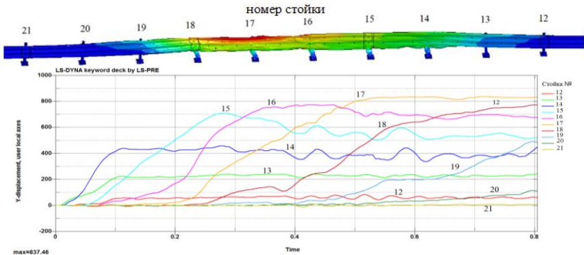
Рисунок 5 – Зависимость прогибов балки барьерного ограждения от времени
