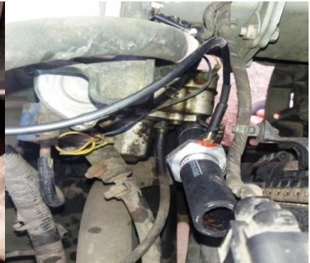
Датчик 4 – Патрубок газового редуктора испарителя
