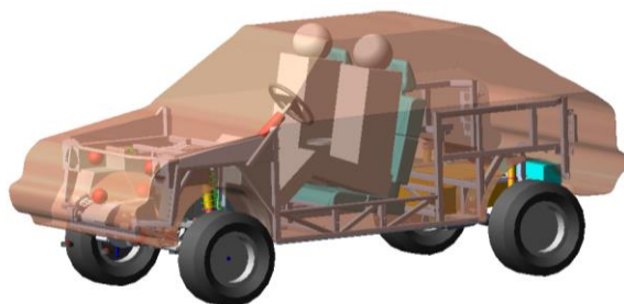
Рисунок 3 – Динамическая модель исследуемого легкового электромобиля в программе Adams Car
