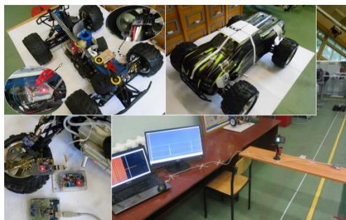
Рисунок 2 – Составляющие измерительно-регистрирующего комплекса, физическая модель автомобиля и испытательная трасса
