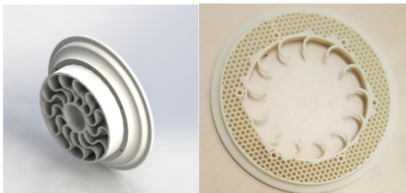
Рисунок 2 – Модель обод колеса и внутренняя структура колеса
