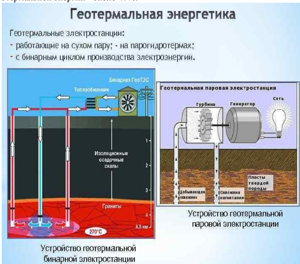
Рисунок 3 – Виды геотермальных электростанций
