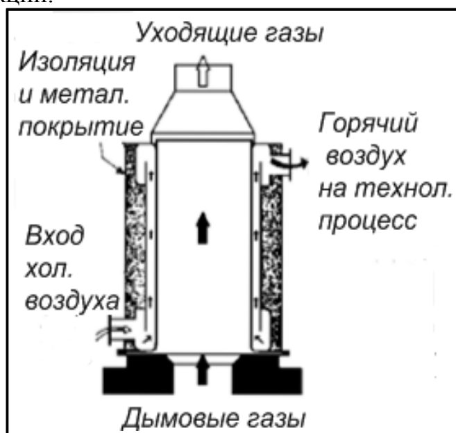
Рисунок 1 – Радиационный рекуператор
