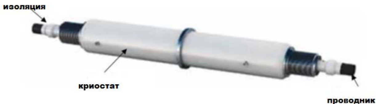
Рисунок 2 – Сверхпроводящее кабельное соединение
