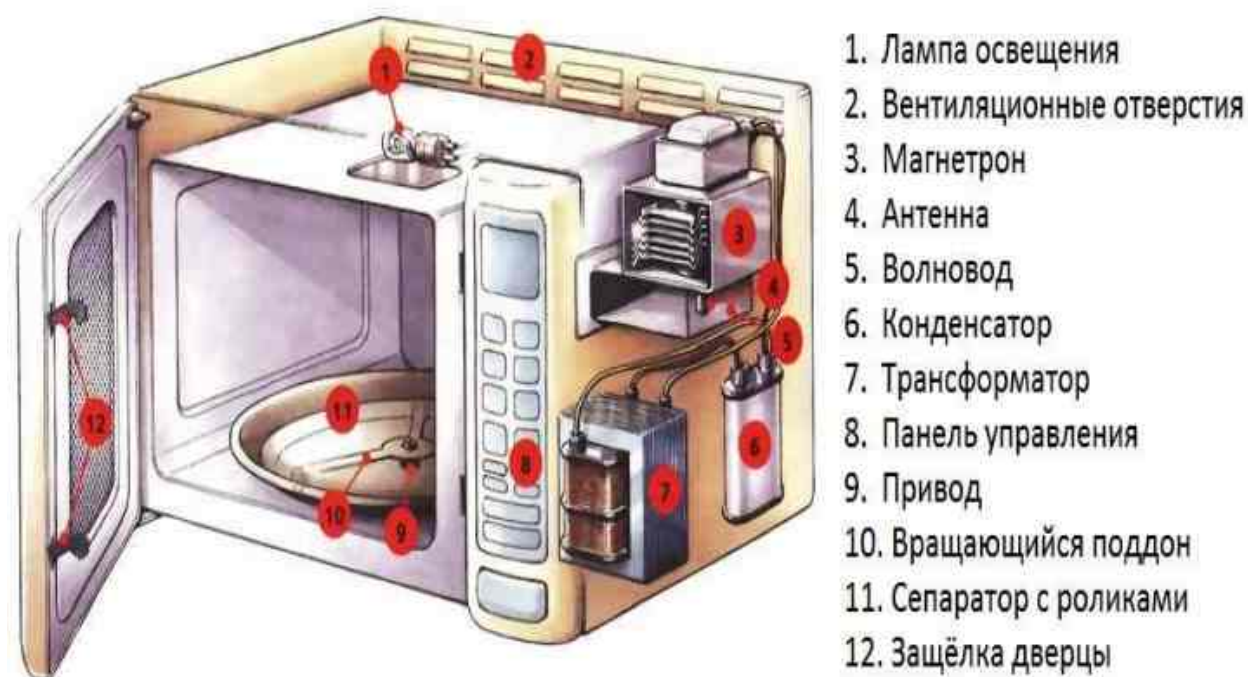
Рисунок 4 – Устройство печи СВЧ
