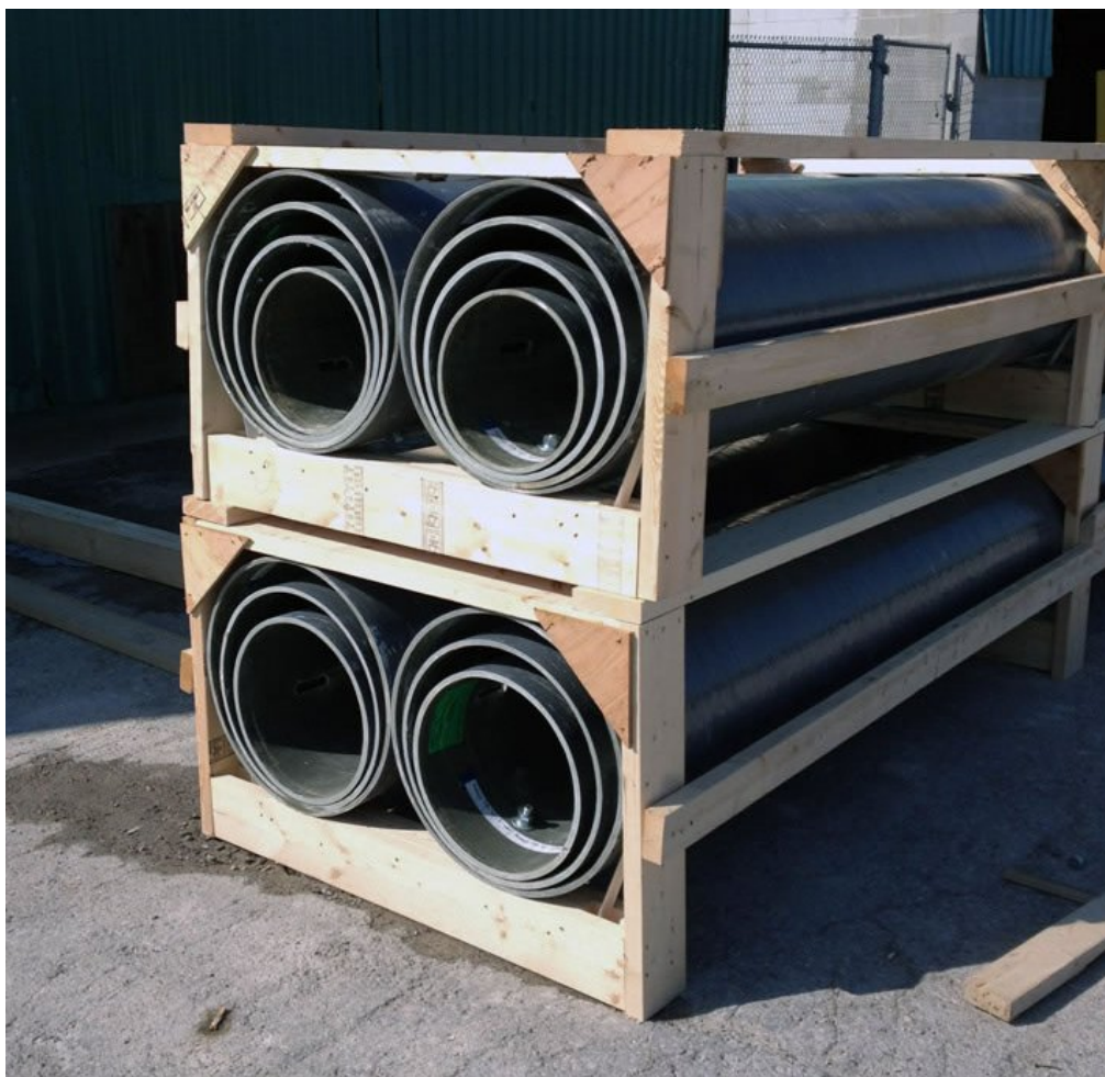
Рисунок 1 – Принцип хранения и перевозки композитных опор
