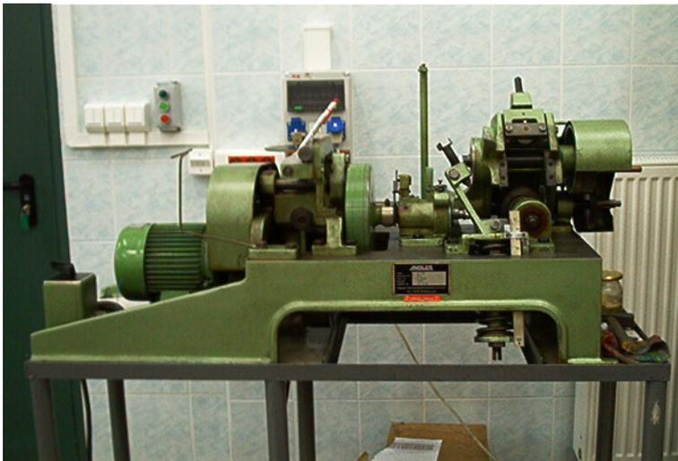
Рис. 2.13. Машина трения Amsler A–135, позволяющая производить эксперименты при постоянных скоростях вращения оси 3,5 с – 1 и 6,6 с – 1 постоянной нагрузке от 4,90 до 1962 Н, а также определять момент трения и работу трения
