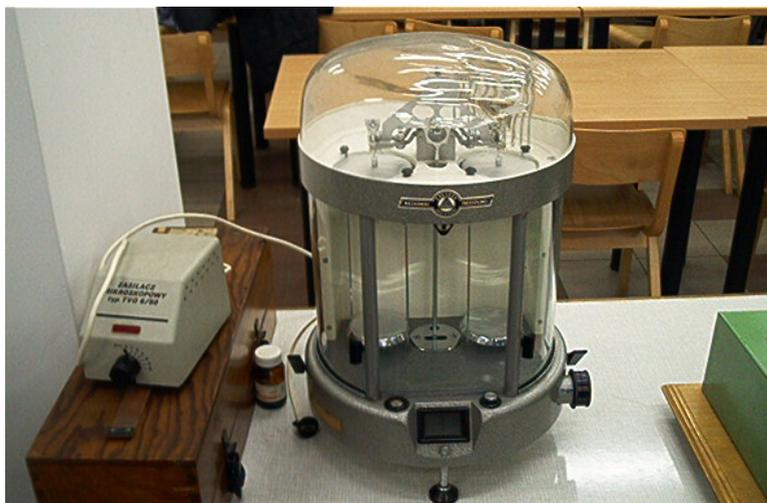
Рис. 2.14. Аналитические весы с точностью измерения 0,1 мг
