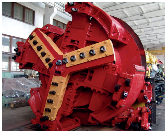
Рис. 1. Соосные роторы проходческого комбайна ПКС-8
