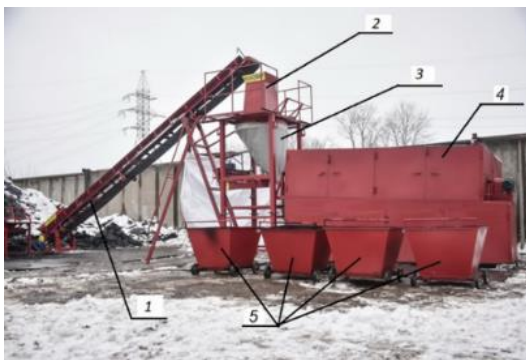
Рис. 1. Технологическая линия для переработки отходов рубероида: 1 – ленточный транспортер; 2 – дробильный агрегат; 3 – отводящий короб; 4 – сортировочный агрегат; 5 – контейнеры
