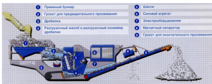
Рис. 3. Оборудование производственной базы для переработки отработанных бетонных и железобетонных конструкций в востребованный продукт – щебень
