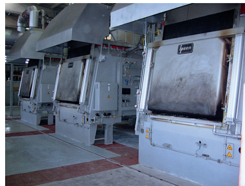
Рис. 4. Автоматическая линия химико-термической обработки деталей на базе печей «IPSEN-TOFR-2-17-ERM»
