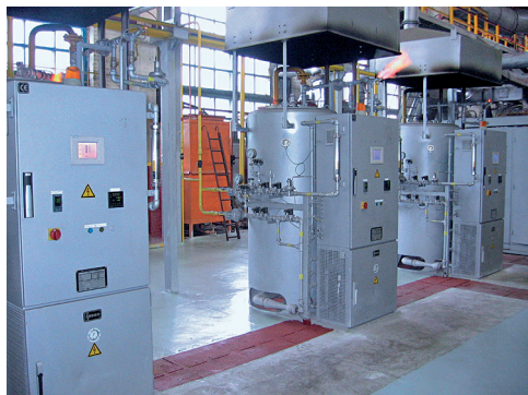
Рис. 4. Автоматическая линия химико-термической обработки деталей на базе печей «IPSEN-TOFR-2-17-ERM»
