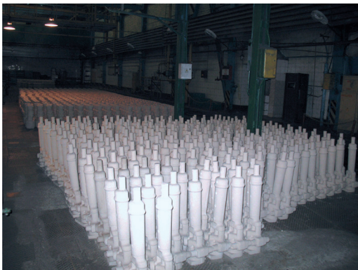
Рис. 9. Изготовление стержней по ХТС-процессу для корпусных отливок
